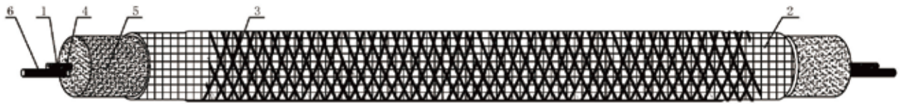
1--MMO丝状阳极；2--耐酸碱覆盖物；3--耐磨编织网；4--导电电缆；5--专用碳填充料；6--专用排气管；
